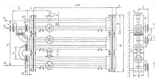
$B_1$  — холодная вода;  $B_2$  — горячая вода;  $B_3$  — циркуляционная линия горячего водоснабжения;  $T_1$  — подающая теплосети;  $T_2$  — выход греющей воды из II ступени;  $T_3$  — вход греющей воды в I ступень;  $T_4$  — обратная теплосеть
