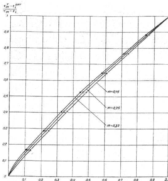
**Рис. 2. Графики изменения температурного критерия системы отопления по температуре воды в подающем трубопроводе —  $\left( \frac{\tau_2^T - t_i^{opt}}{\tau_{21} - t_i} \right)$  для различных значений показателя степени  $m$  и при постоянной циркуляции теплоносителя в системе**
