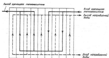
Рис. 2. Несимметричная компоновка пластинчатого водоподогревателя, обозначение Сх (2 + 2)/5
