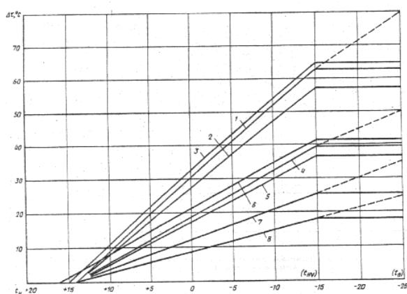
Рис. 6. Графики изменения разности температуры воды в подающем и обратном трубопроводах системы отопления  $\Delta t$  в зависимости от  $t_h$
