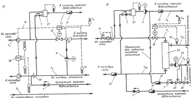
**Рис. 9. Схемы присоединения систем горячего водоснабжения и отопления в ИТП при зависимом (а) присоединении системы**
