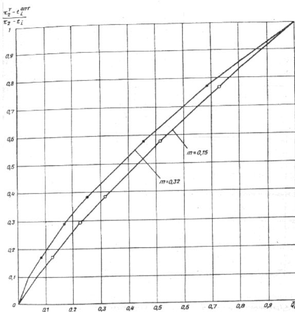
**Рис. 3. Графики изменения температурного критерия системы отопления по температуре воды в обратном трубопроводе  $\left( \frac{\tau_2^T - t_i^{opt}}{\tau_{21} - t_i} \right)$  при постоянной циркуляции воды в системе**
