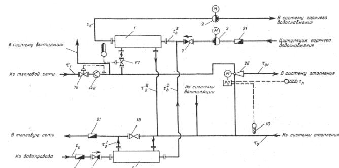
**Рис. 5. Двухступенчатая схема присоединения водоподогревателей горячего водоснабжения в ИТП с водоструйным элеватором и автоматическим регулированием расхода теплоты на отопление (пример учета теплоты по водомерам)**
