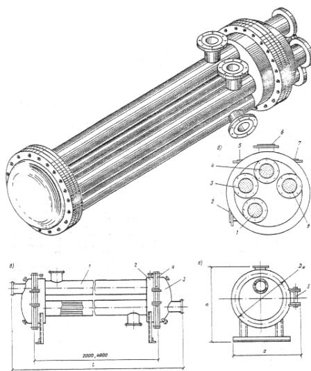
**Рис. 5 Общий вид горизонтального многоходового кожухотрубного водоподогревателя**
